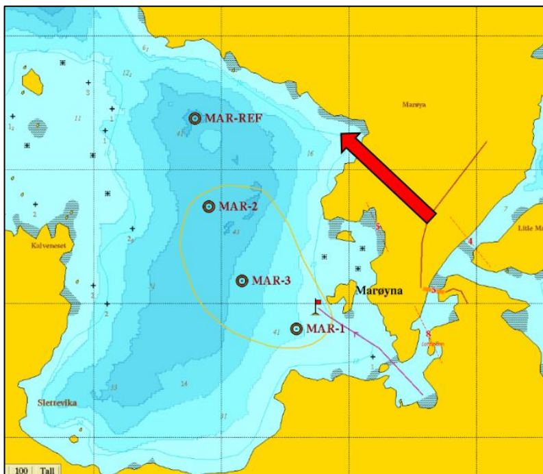
Figur 4. Utsleppsleidningen frå anlegget (lilla strek), antatt influensområde for utsleppa (gul strek), hovudstrømretning (raud pil) og prøvepunkta frå miljøgranskinga, frå Åkerblå 2022 2 .
