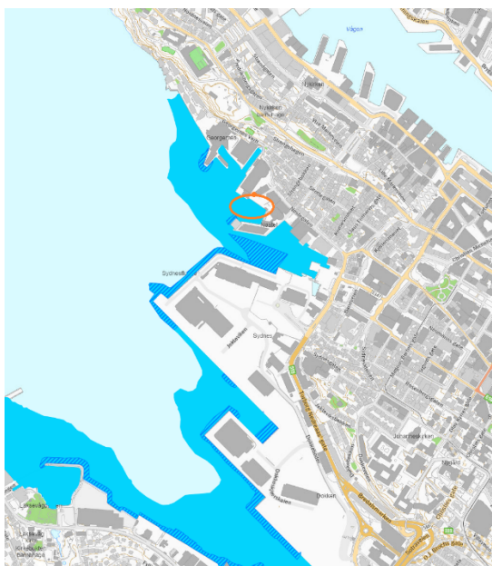
Figur 5 Blå skraver viser tildekkingslag over forurenset sjøbunn, etablert 2018. Renere Puddefjord prosjektet. Oransje ring viser planlagt utfylling i sjø.
