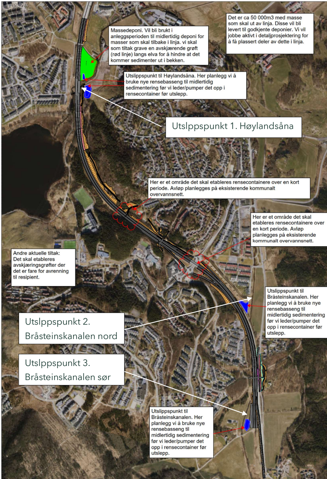
Figur 14. Oversikt over entreprenørens planlagte områder for deponi, samt områder for plassering av renseløsninger og utslipp. Kartet er utarbeidet av totalentreprenør. Det bemerkes at avskjærende grøfter ikke er tilstrekkelig som rensesystem, men vil redusere vannmengden inn til rensesystemet. Grøfter vil også kunne etableres for å lede anleggsvann inn til sedimenteringsbassengene.
