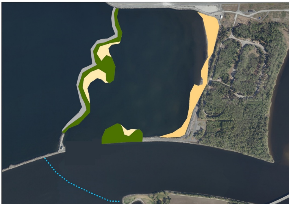
Figur 3.3. Skisse av mulig utforming av alternativ 2, hvor en del av eksisterende molo er fjernet og ny mer natur-lik fylling/molo/ør er lagt nordover til flystripa. Grønne områder representerer vegetasjon, gule er grunne sandområder, og oransje områder er potensielle arealer for strandeng/sump. Stiplet blå linje illustrerer en potensiell terskel for å øke ferskvannspåvirkningen i det nye området.
