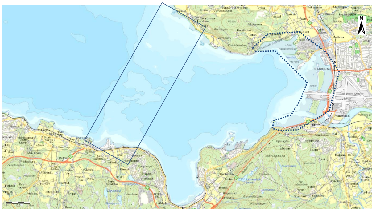
Figur 2: Sjøkart som viser terskelen mellom Midsanden i sør og Skjærvøra i nord (område innenfor heltrukket rektangel), samt tidevannsflatene med bløtbunn i indre deler av Stjørdalsfjorden (lysegrå områder innenfor stiplet område). Kote -50 m og -100 m er markert med grå linjer i kartet. Kilde: Multiconsult
