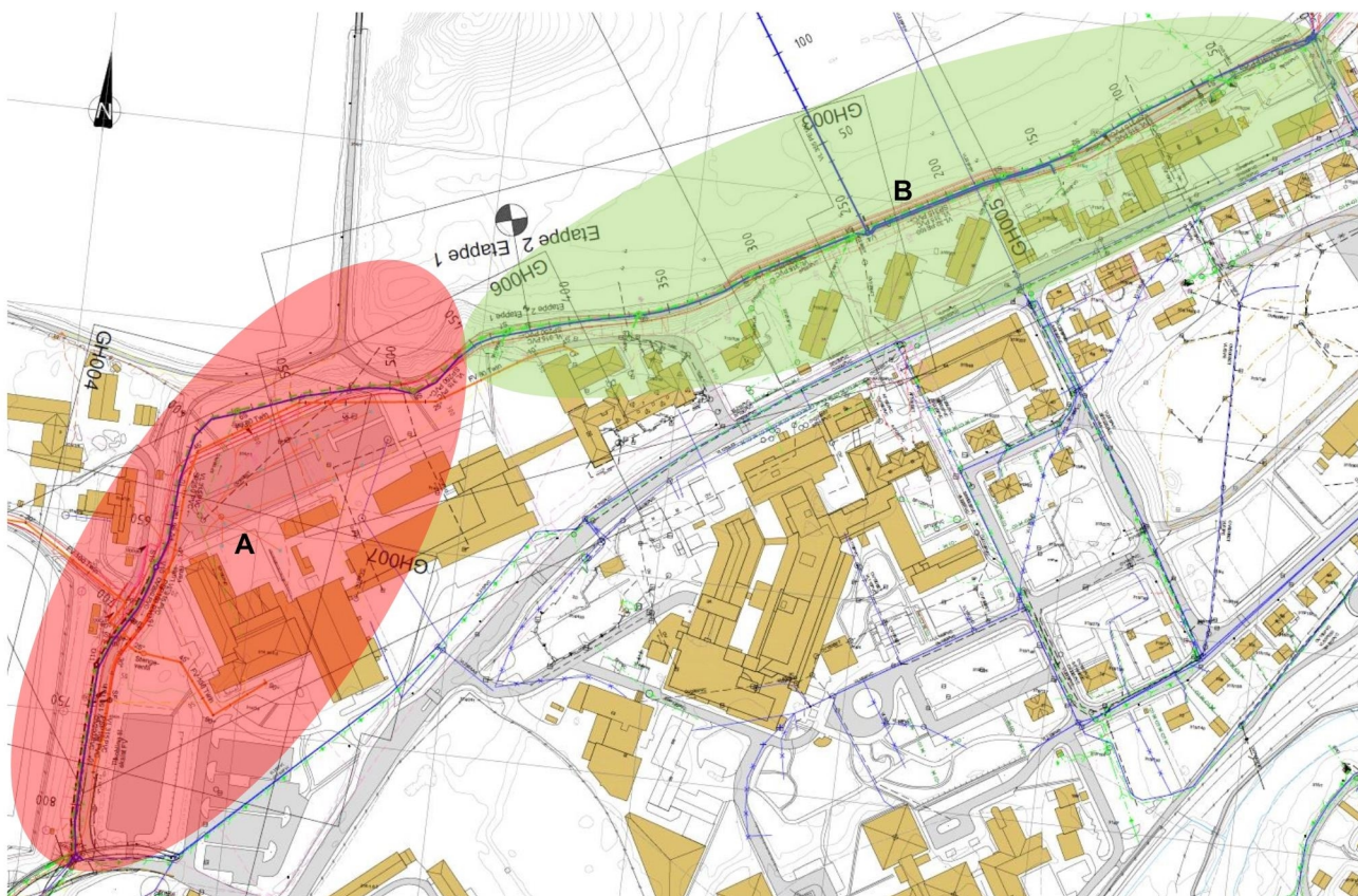
Figur 3 Utklipp fra GH001_F01 som viser plassering av VA-trasé og inndeling i områder for grunnforhold.
