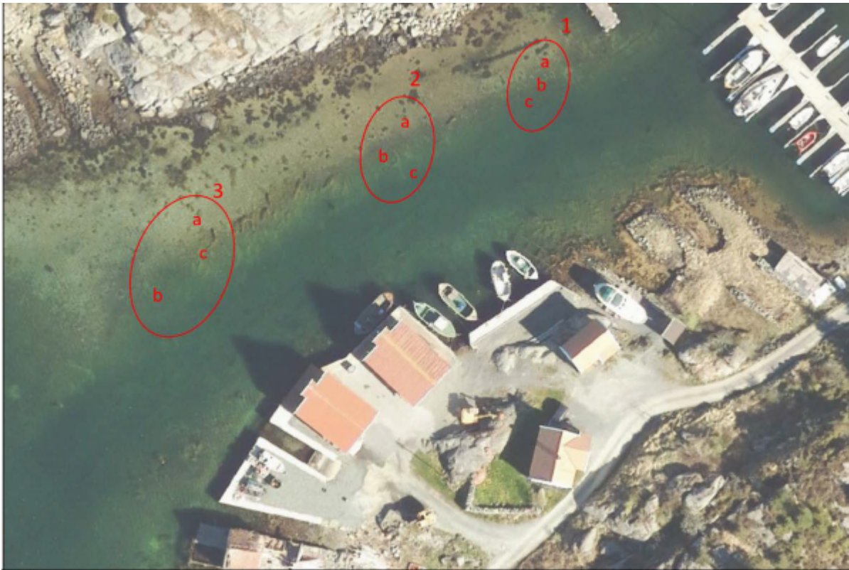
Bilde 2: Plassering av prøvetakningsstasjoner. Punkter merket a-c er slått sammen til blandeprøve. Blandeprøvene (merket 1-3) er sendt til kjemisk analyse. Ref: NGI Teknisk notat, 13.12.2018, dok nr: 20180967-01-TN, prosjekt «Analyse av prøver fra Syre Båtforening».
