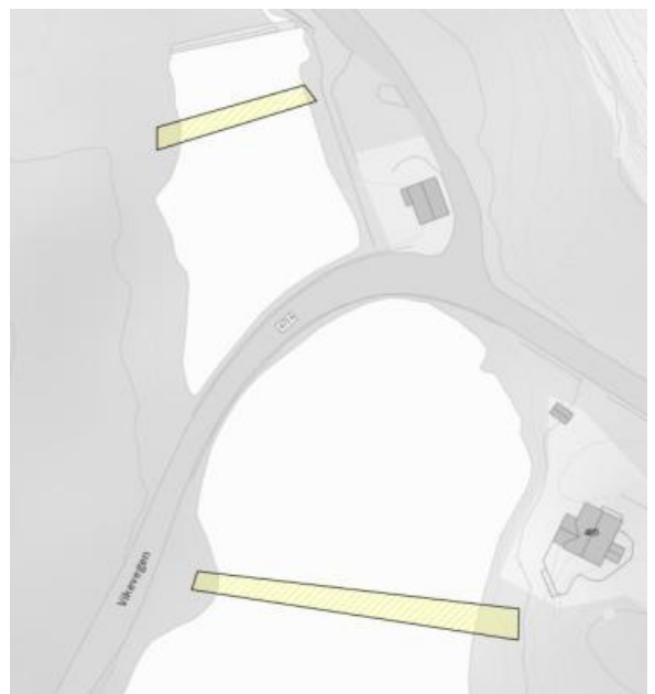
Figur 2 - Foreslått plassering av siltgardin med oljeabsorberende lense. Figur er hentet fra rapporten «Miljøteknisk sediment-undersøkelse», s. 10.
