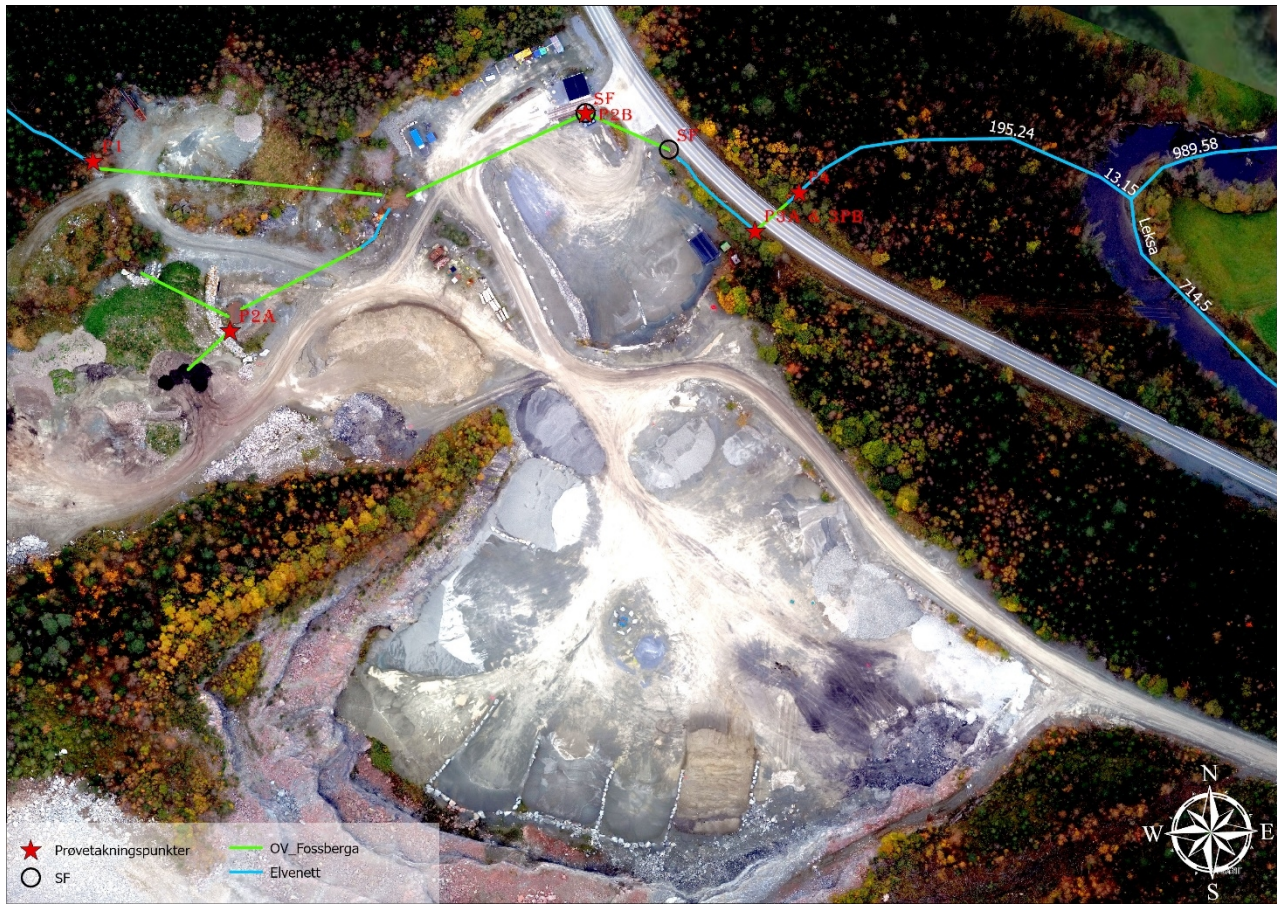
Figur 1: Oversikt over rørledninger og sandfang/kummer i Fossberga
