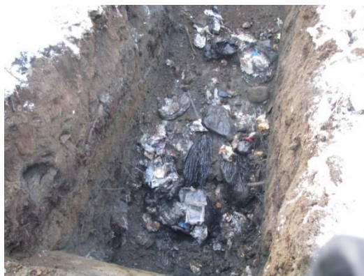
Figur 8: Sjøppel i sjakt 5 fra grunnundersøkelsen utført av Asplan Viak vinteren 2012/2013.
