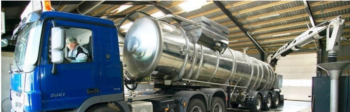
Bilde 7 Mottak av substrat vil foregå innendørs og med avtrekk og ventilasjon som renses før utslipp
