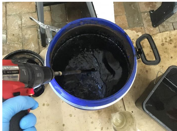
Figur 1 - Kugjødse blannes før det doseres i mindre bøtter
