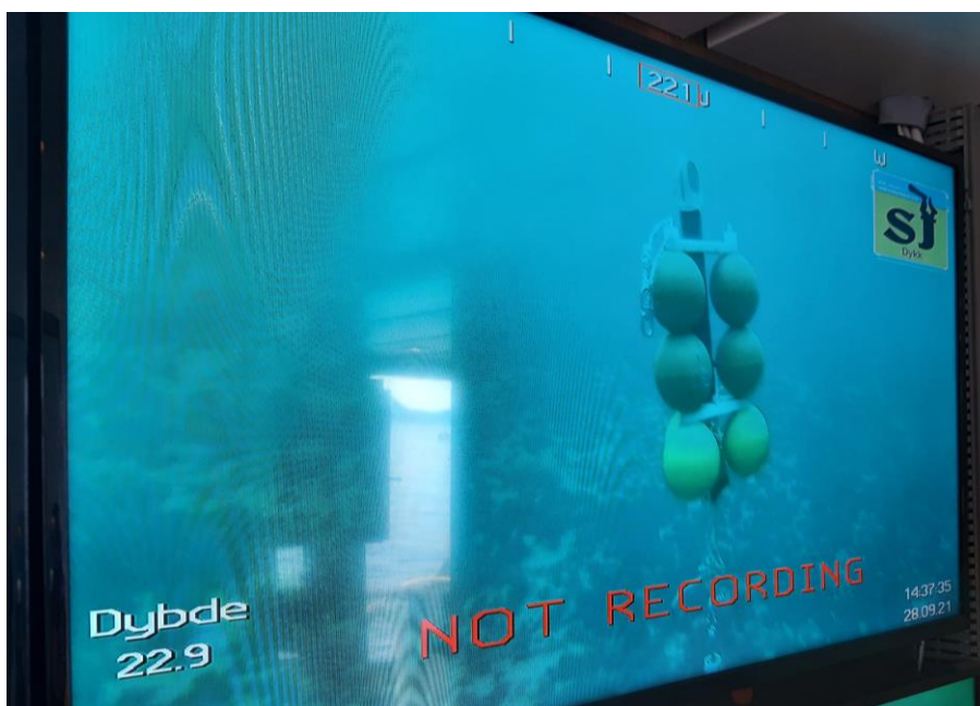
Figur 15 Bilde av ROV filming for å sikre at riggen sto som den skulle
