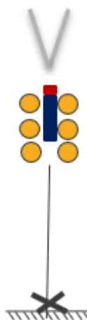
Figur 13: Skisse av riggen ved Mågøya sør. Riggen var satt ut med en akustisk utløser.
