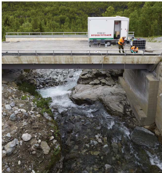
Figur 7. Hoveddosering med 300-serie peristaltpumpe (venstre bilde) som er svært pålitelig og gir en presis dosering av CFT-Legumin. Batteripakker med sikring og vanntett forsegling ble brukt ved dosering med 300-serie pumpe. Til høyre eksempel på en hoveddoseringsstasjon.
