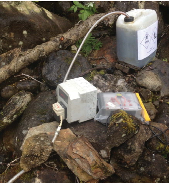
Figur 7. Hoveddosering med 300-serie peristaltpumpe (venstre bilde) som er svært pålitelig og gir en presis dosering av CFT-Legumin. Batteripakker med sikring og vanntett forsegling ble brukt ved dosering med 300-serie pumpe. Til høyre eksempel på en hoveddoseringsstasjon.
