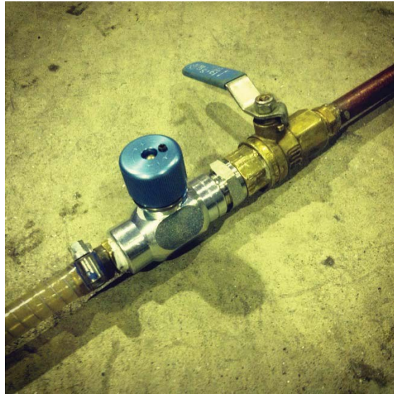
Figur 6. Klargjøring av raftingflåter (venstre bilde). Disse benyttes uten påhengsmotor. Vekt, stabilitet og oppdrift gjør disse flåtene svært egnet på elva. Ny reguleringsventil (høyre bilde) for CFT-Legumin ble koblet på pumpeinnsuget og testet i en av disse flåtene.
