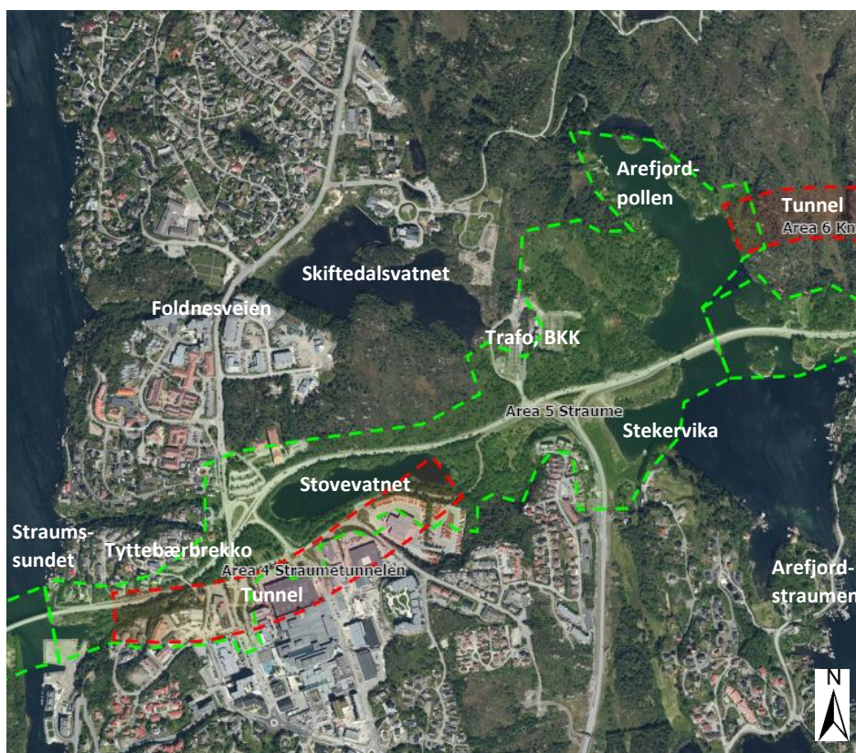
Figur 2: Oversiktskart Straume (Kilde: Prosjektet sin GIS-portal). Veianlegget for Sotrasambandet, dagsoner, er vist med grønt. Planlagte tunneler er vist med rødt.
