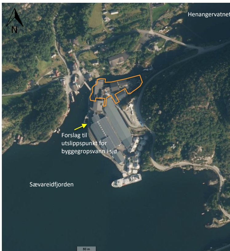
Figur 8-1: Flyfoto med lokalisering av tiltaksområdet for nytt bygg (omtrentlig avgrenset med oransje linje), og foreslått plassering av utslippspunkt i sjø for byggegropsvann (vist med gul pil). Foto: www.norgeskart.no .
