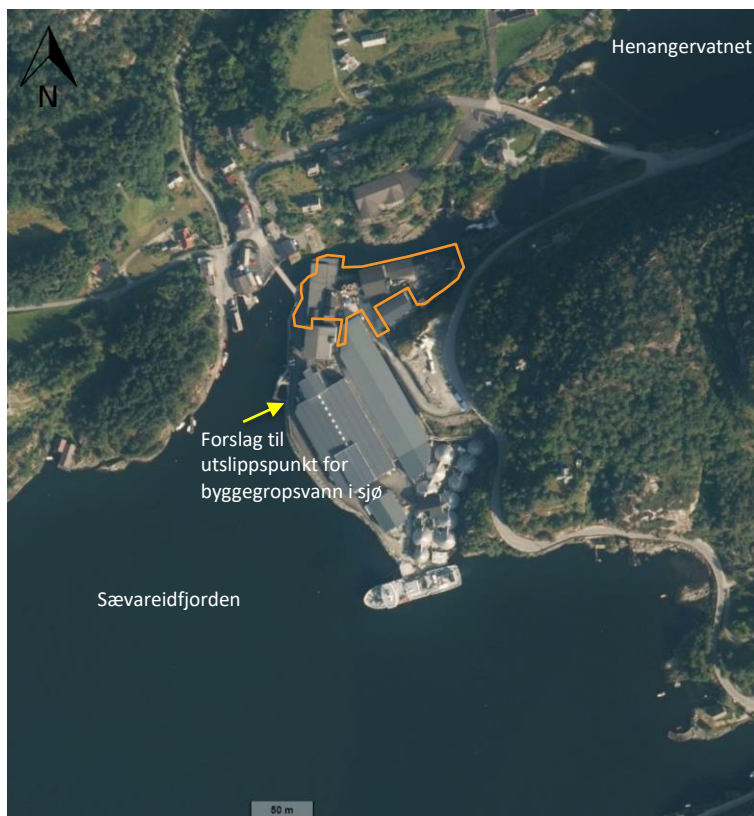
Figur 4-1: Flyfoto med lokalisering av tiltaksområdet for nytt bygg (omtrentlig avgrenset med oransje linje), og foreslått plassering av utslippspunkt i sjø for byggegrøpsvann (vist med gul pil). Foto: www.norgeskart.no .
