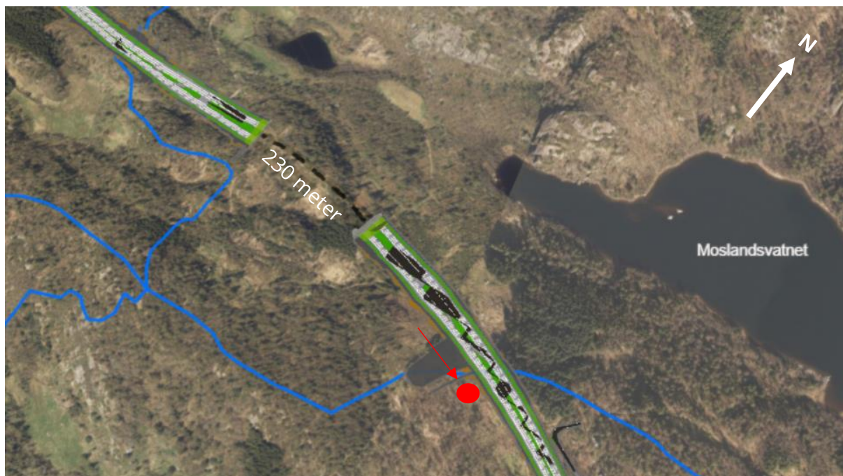
Figur 3. Lokalisering av Skreheiatunnelen, vest for Moslandsvatnet. Renset tunneldrivevann skal transporteres ut av nedbørsfeltet til Moslandsvatn (blå strek) og inn i nedbørsfeltet til Sodelandsbekken. Den eksakte plasseringen av dette utslippspunktet må avtales i en dialog mellom Nye Veier/ (TE) og SFA.
