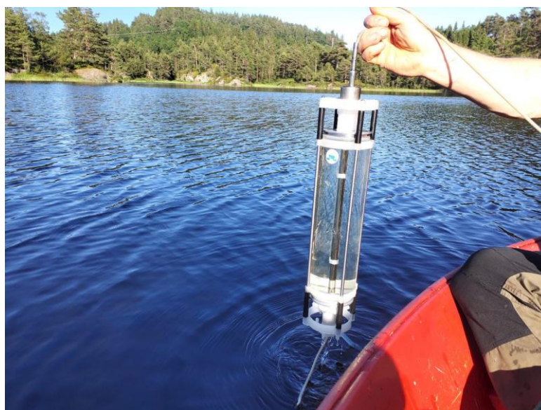
Figur 0-8. Innhentning av blandprøve gjort ved vannhenter.
