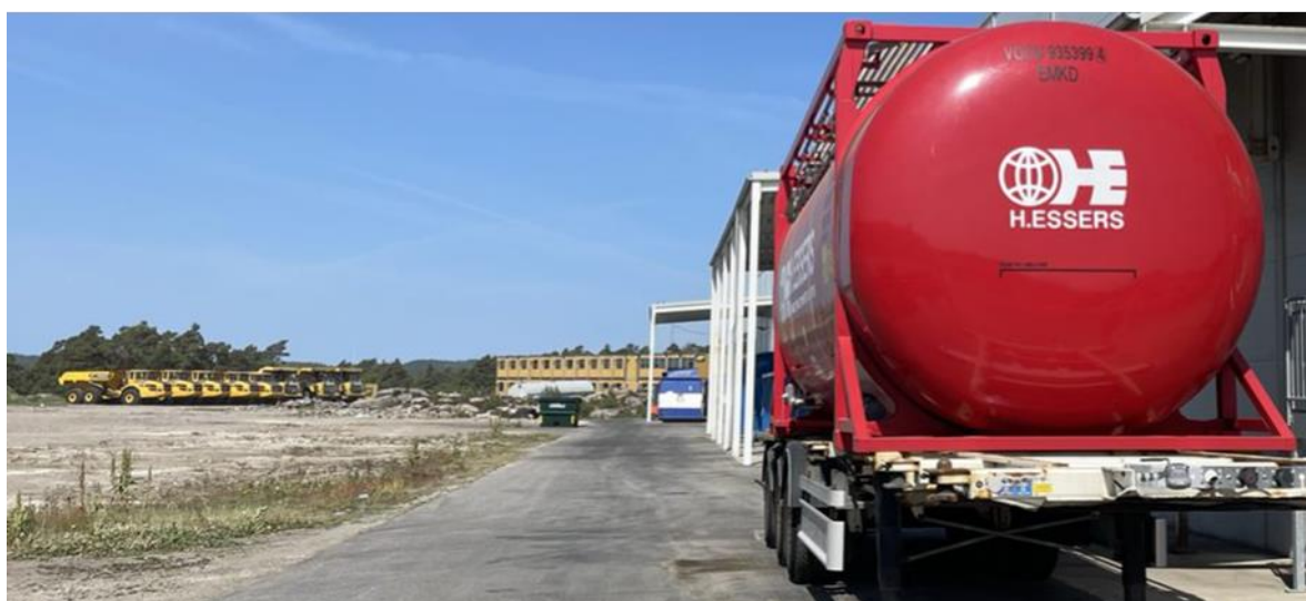
Figur 15 Ved fylling av ny peanøtt- eller solsikke olje benyttes mobile tanker som kobles til Sørlandschips AS sitt anlegg.
