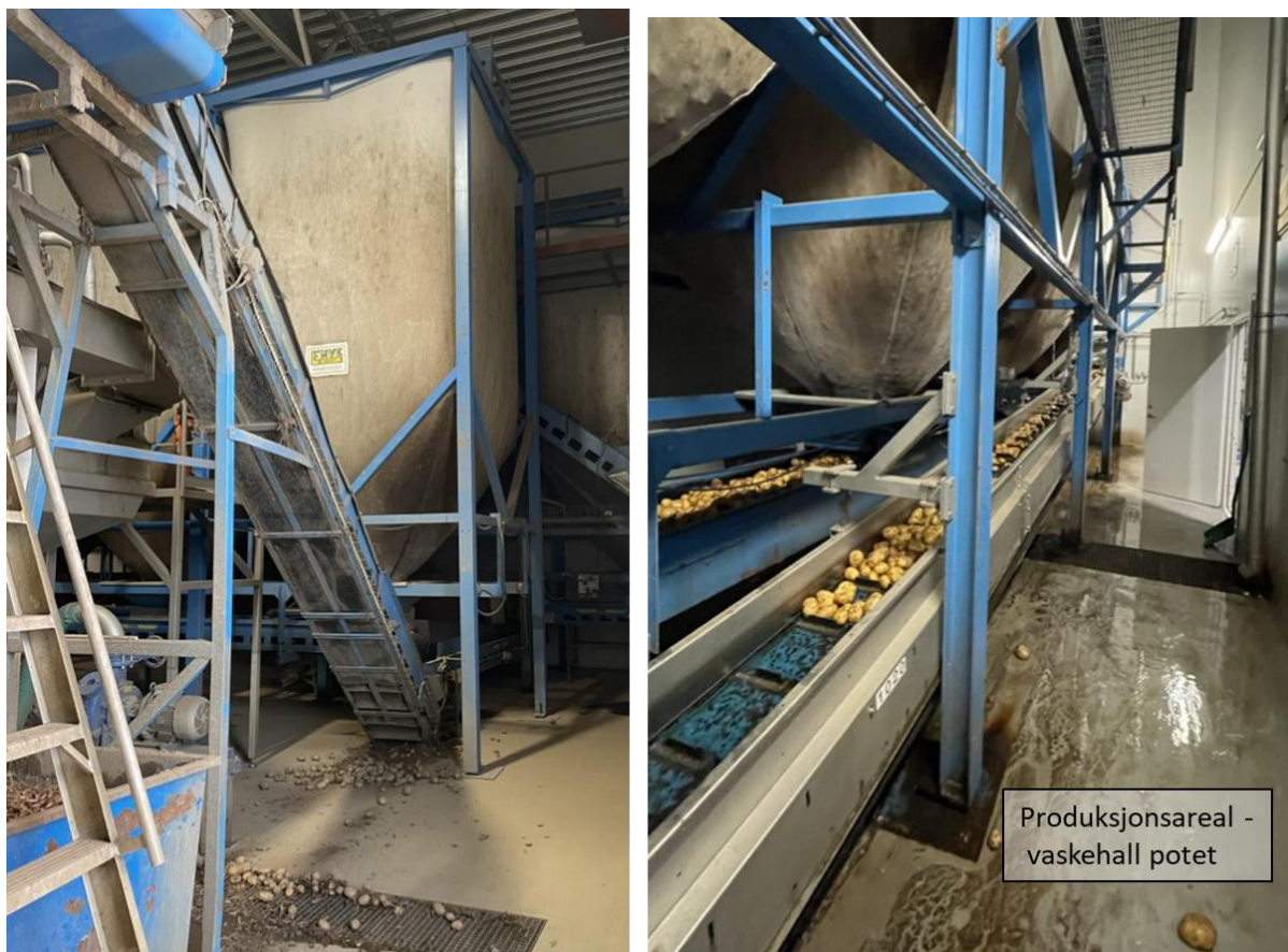
Figur 7 Deler av produksjonsareal; sikting og vasking av potet. Vann drenerer til sluker/rist i gulvet.
