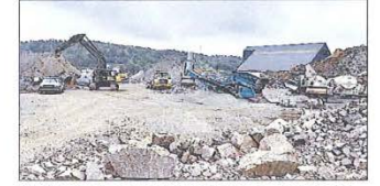
KNUSER: Klodeberg og Landvik pukverk sprenger ned fjellet på Eydehavn og knuser det til pukk og grus.
