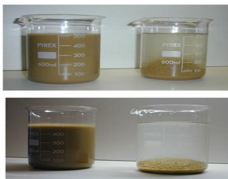
Flokkulering og sedimentation
