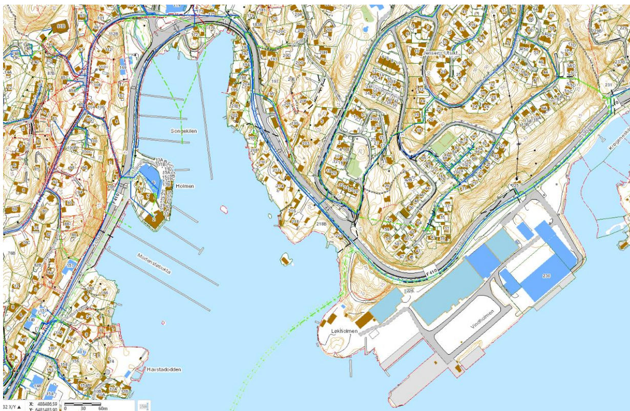
Figur 18: Vann og avløpssystem ved tiltaksområdet (Arendal kommune, 2018). Grønne ledninger er spillvann, svarte er overvann og blå er vannledninger.
