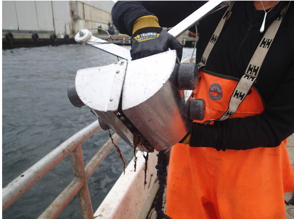
Figur 27: Van Veen grabb. Her tom grabb pga. stein i åpningen. Fra prøvetaking av S5, inne i gammel slipp.
