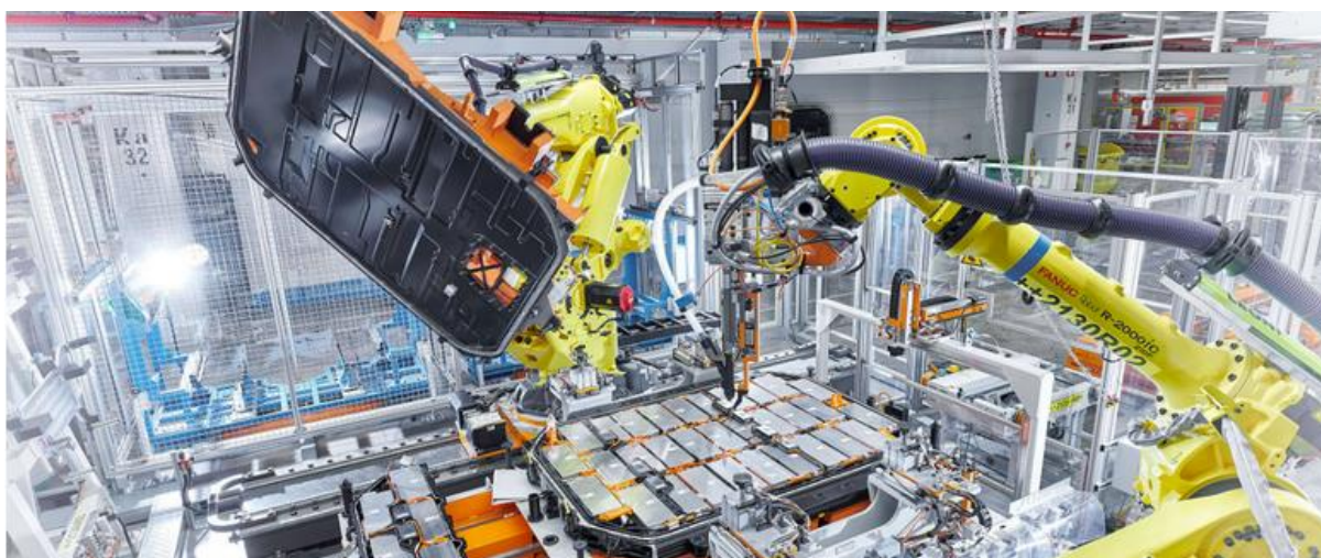
Figur 3. Eksempel på automatisert produksjon av flat batteripakke ("skateboard chassis") i en Audi e-tron 15 .
