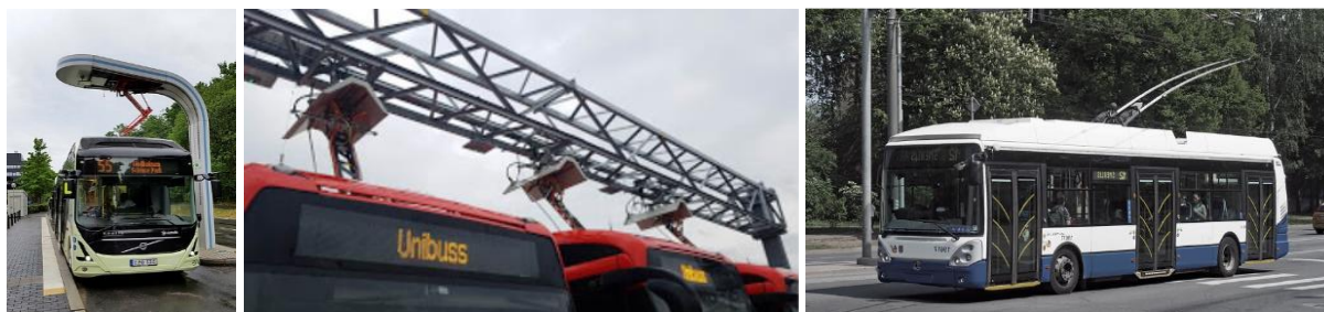
Figur A 88. Ulike løsninger for lading av buss. Fra venstre: pantograflading, omvendt pantograf og trolleybuss. Foto: NVE.
