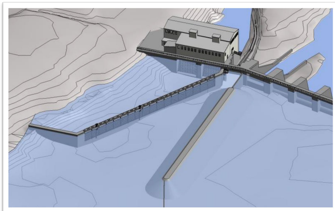
Figur 21 Principutförning för en möjlig avledare vid Edsforsens kraftverk, i detta fall ett enkel \beta -galler med tillhörande stenpir (Norconsult 2017).
