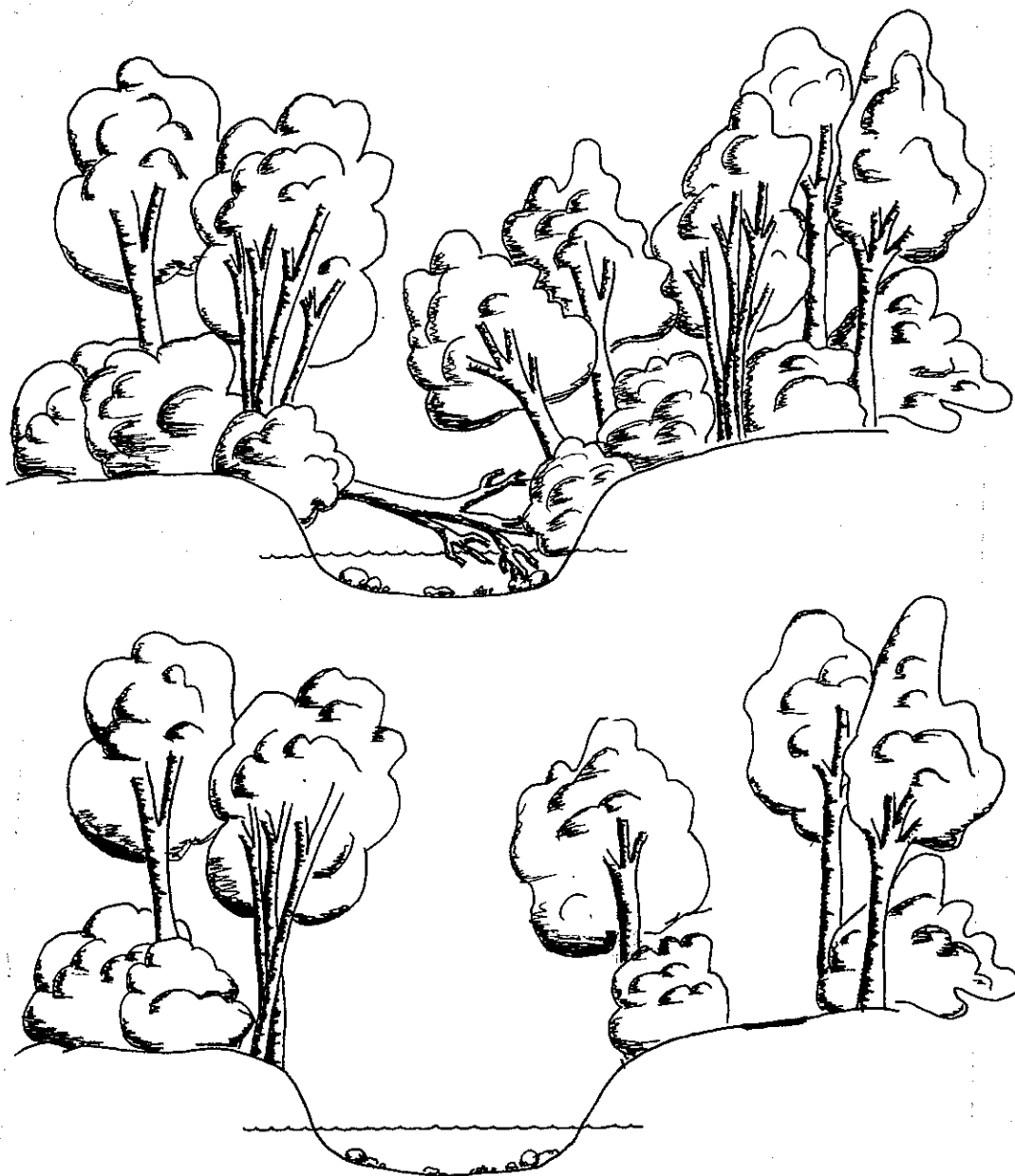
Figur 3. Prinsippkisse for tynning av vegetasjon langs vassdrag.
