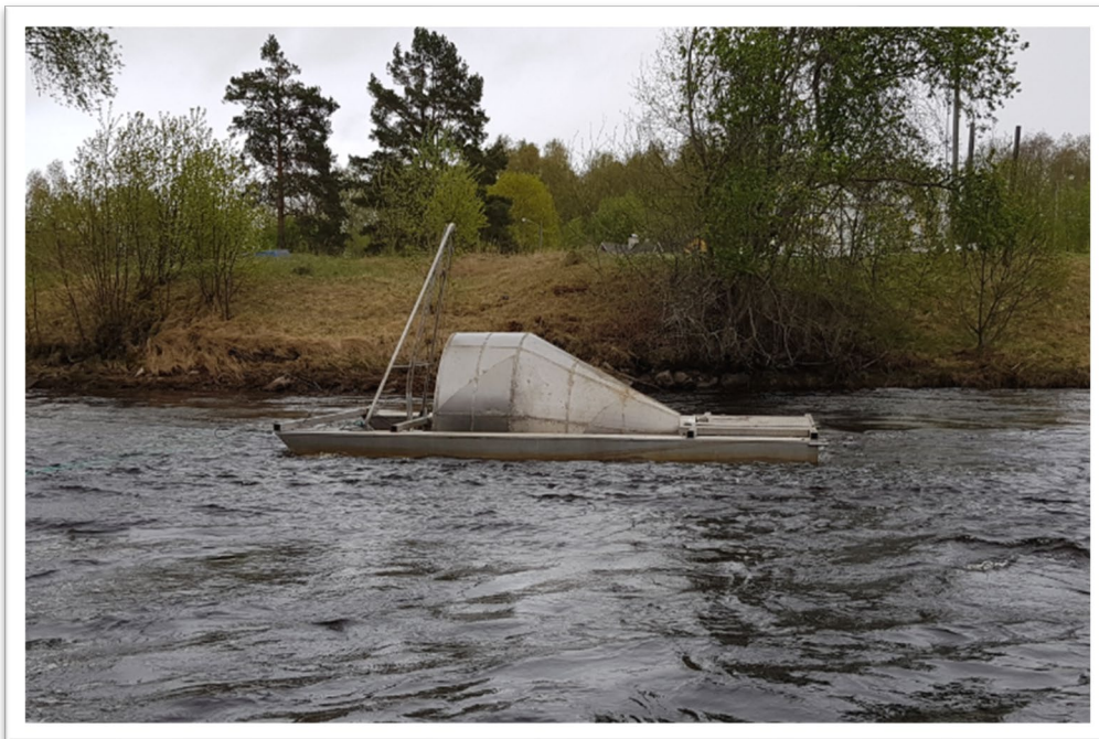
Figur 37 Smoltskruven i drift strax uppströms bron i Edebäck. Trummans rotation drivs av vattenströmmen och den fisk som fångas in samlas i en sump i fällans bakkant.
