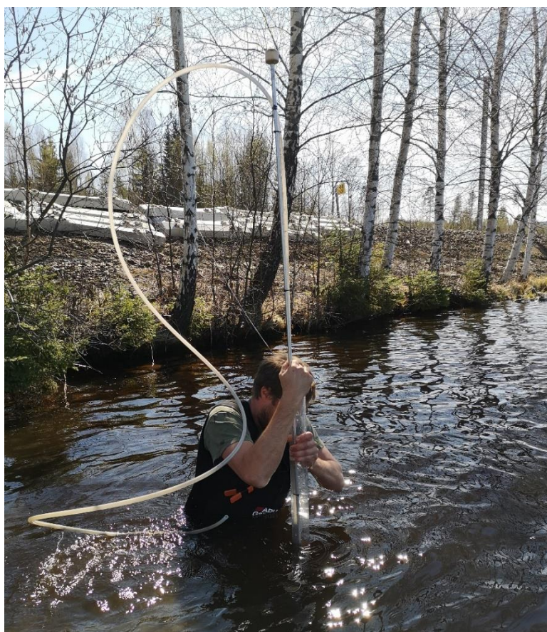
Figur 5.3: Uttak av sedimentprøver med kjerneprøvetaker.
