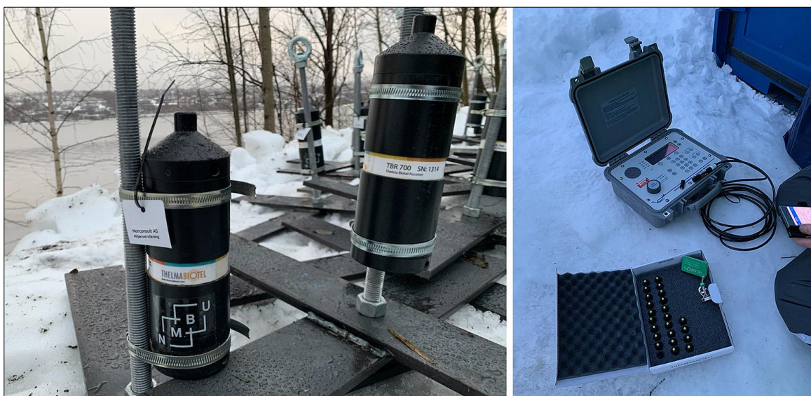
Figur 85. Passive lyttebøyer av type Thelma Biotel TBR 700 ble brukt i lakeprosjektet for å fange opp og lagre informasjon om merkede fisker innen de respektive lyttebøyenes dekningsområde.
