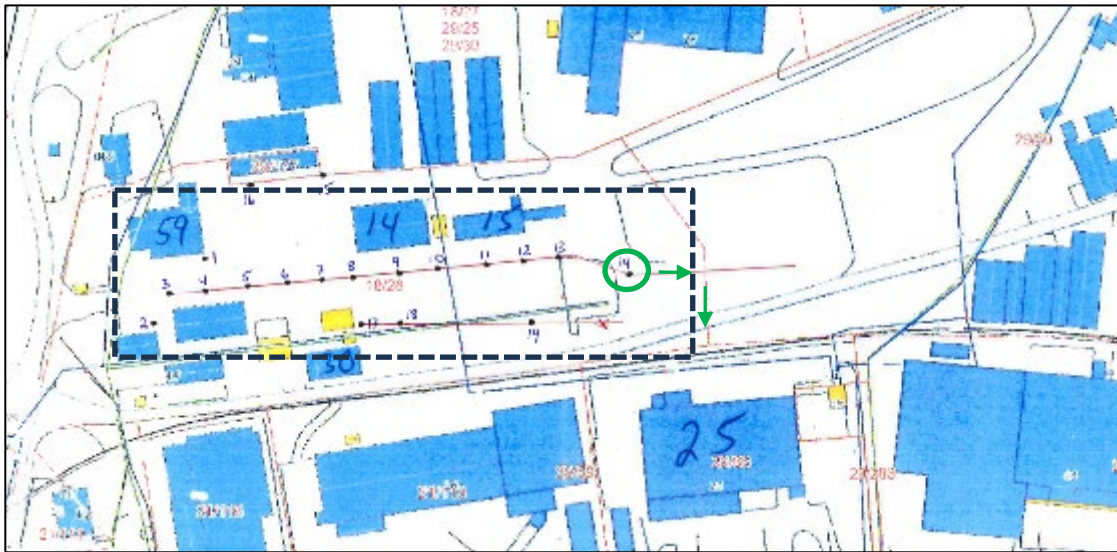
Figur 3-2. Kummer på lokaliteten som drenerer overvann til grøft med utslipp direkte til Gardsjøen via Stordika. Skravert rektangel viser omtrentlig omriss av området som har blitt lagt til grunn for generering av overvann til kummene.
