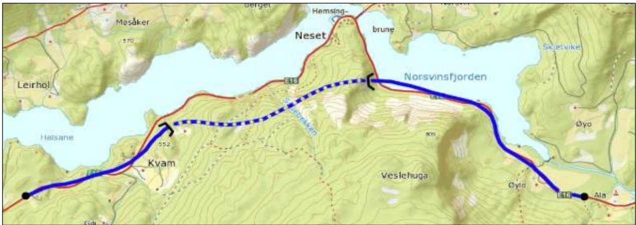
Figur 3: Ny vegtrasé E16 Øylo – Synshagen. Stiplet linje angir ca. 1,8 km lang tunnelstrekning mellom Hugavike og Støtabekken.
