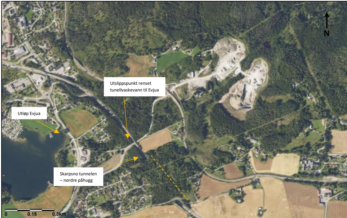
Figur 3: Oversiktskart over Skarpsnoberget. Gul stiplede linje viser omtrentlig plassering av nytt tunnelløp. Det er et steinbrudd og en gammel avfallsfylling oppstrøms Evjua.
