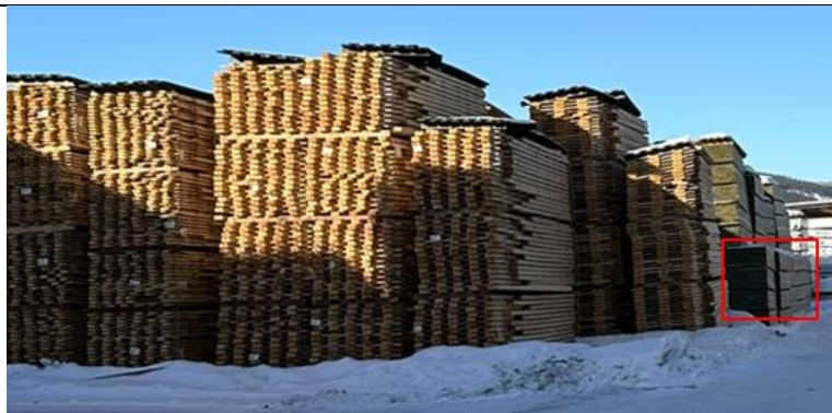
Lagring av både ikke-impregnert og impregnert trevirke. Impregnert trevirke har en grønnlig farge. Nederste rad av det impregnerte trevirket er lagret uten taklem, og vil være eksponert for nedbør. Dette er markert med rød ring. Virksomheten arbeider med å utbedre dette.
