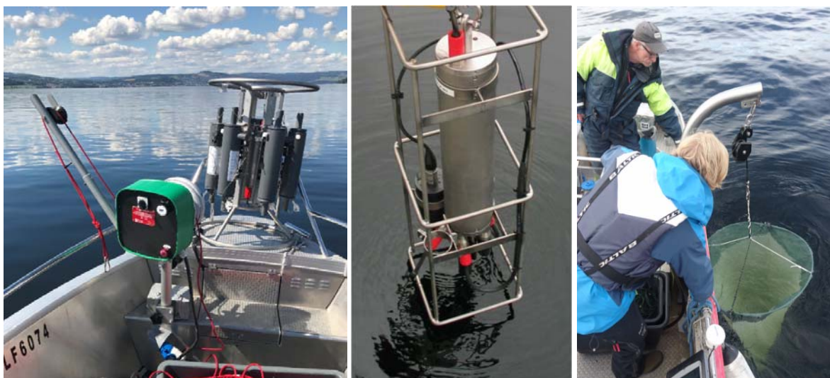
Figur 2. Båt fra Statens Naturoppsyn med løftekran og motorisert linehaler, samt feltutstyr brukt i 2018: fra venstre mot høyre: Rosett-samler med 6 prøveflasker, multisensor-sonde for måling av vertikalprofiler, Mysis-håv for dyreplanktonprøver fra hele vannsøylen.
