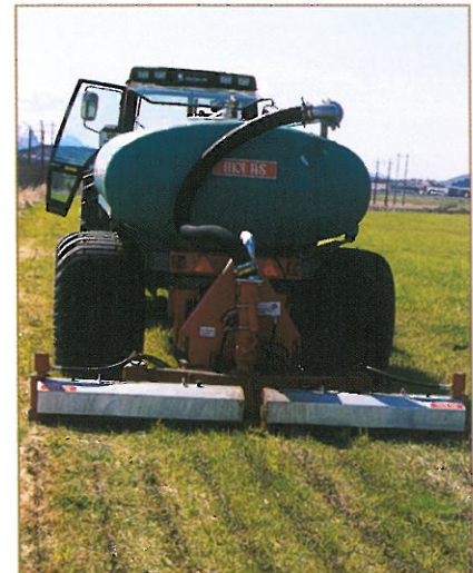
DGI gjødselnedfeller i arbeid. Hvis ønskelig kan såfrø blandes med gjødsel i tanken, eller spres med eget såutstyr (ikke på bildet).
