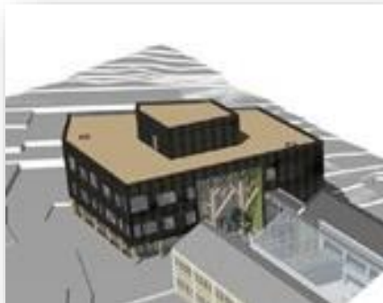
Hadsel videregående skole i massivtre.
