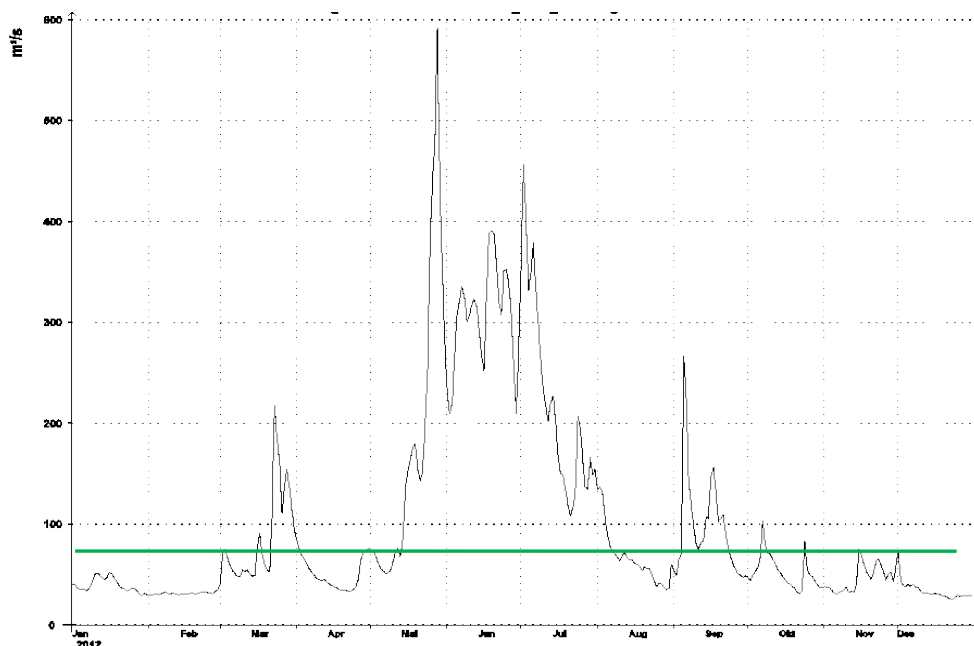
Figur 2 Vannføringskurve (30-års middel) for målepunktet Joibakken (nr:151.21) som ligger nederst i Austervafsa. Den grønne linja viser vannføringa under boniteringa 8. august 2012.
