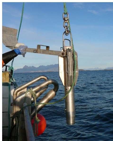
Figur 1. Prøvetakingsutstyr brukt i Salten. Ovenfor vises en van veen grabb og til høyre en Niemistö kjerneprøvetaker.
