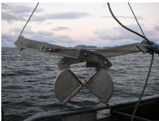
Figur 1. Prøvetakingsutstyr brukt i Salten. Ovenfor vises en van veen grabb og til høyre en Niemistö kjerneprøvetaker.
