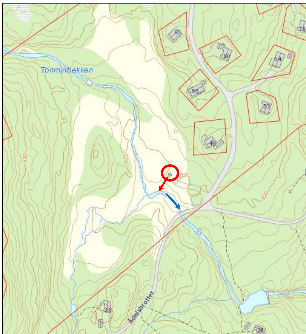
Figur 10: Hovedpumpestasjon Åsland, med nødoverløp til Tonmyrbekken, som renner ned i Ådalselva.
