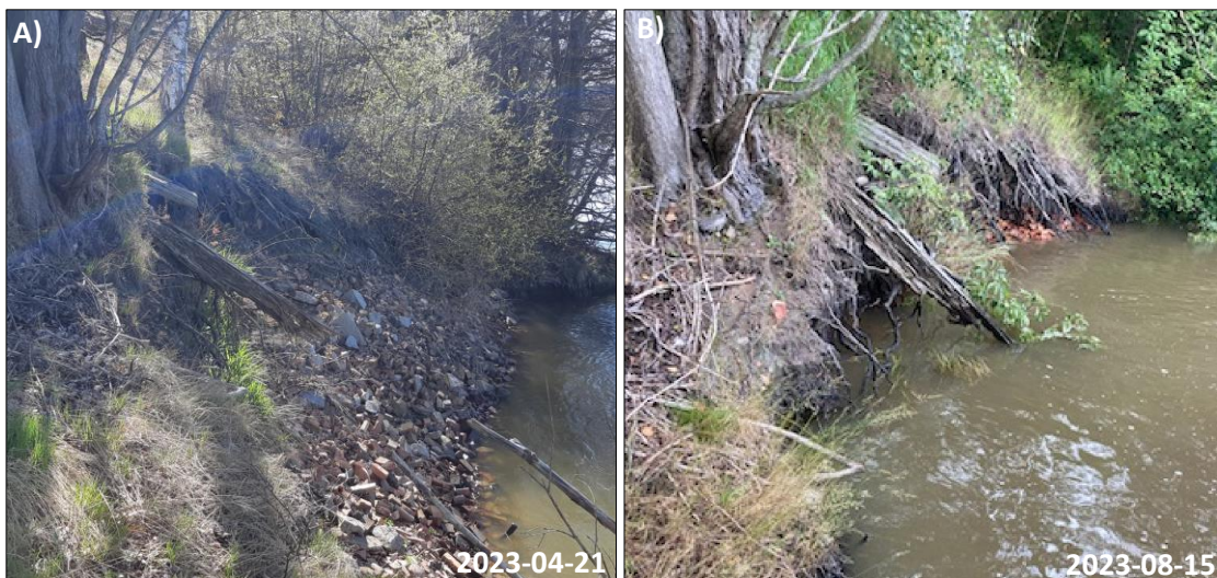
Figur 3.9: Omtrentlig stillfoto av erosjonssår nr. 1 A) før og B) etter flommen «Hans».
