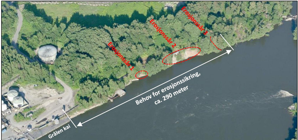
Figur 6-4. Topografiske forhold langs elvebredden der det skal erosjonssikres. Erosjonssårene er indikert med rødt og strekningen som skal erosjonssikres er indikert med hvit pil.
