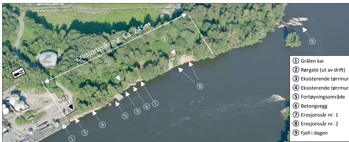
Figur 4 Infrastruktur og topografiske forhold langs elvebredden der det skal erosjonssikres.
