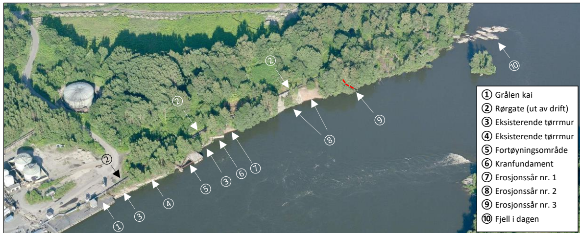
Figur 3.1: Infrastruktur og topografiske forhold langs elvebredden der det skal erosjonssikres.
