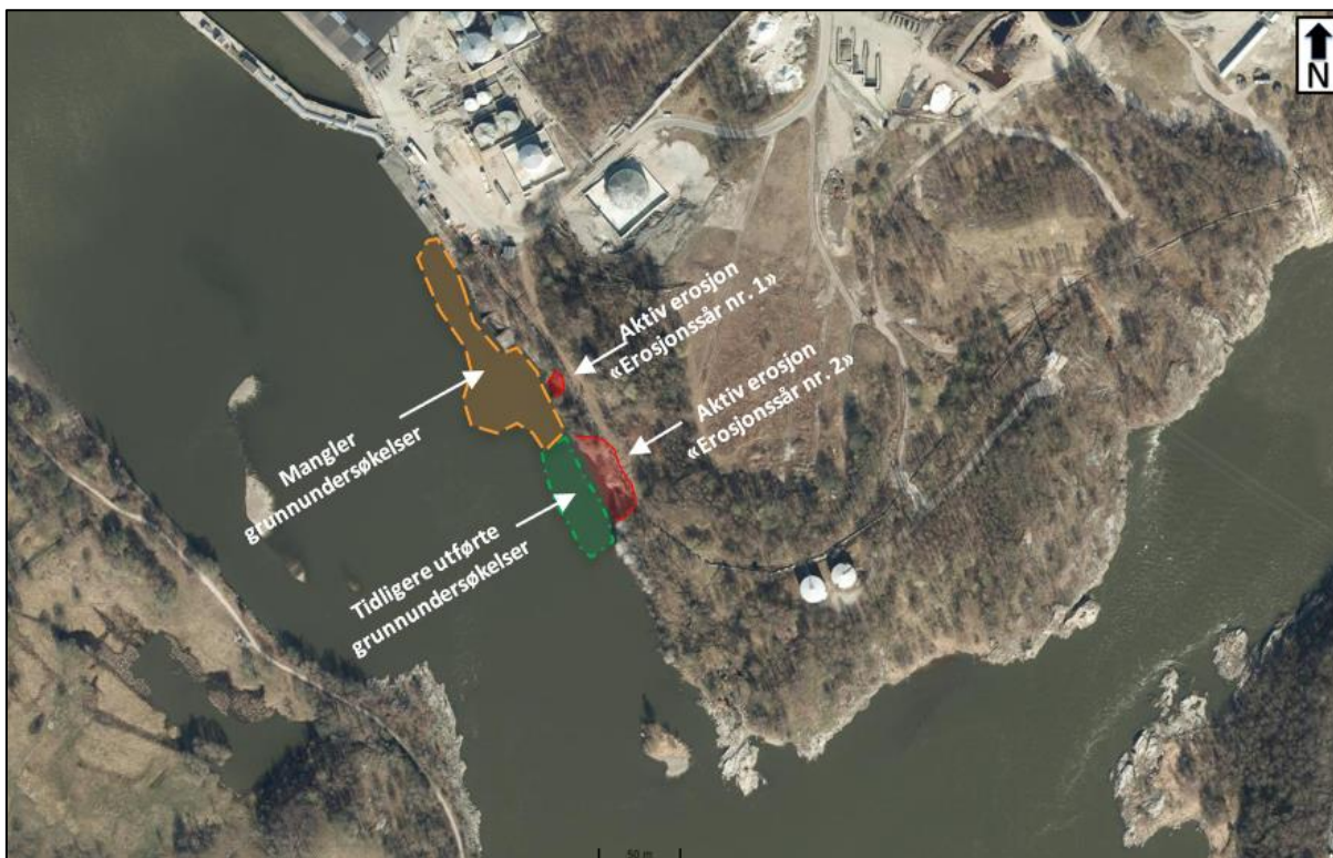
Figur 1-2. Oversikt over lokasjon på erosjonssår 1 og 2, samt hvor det er gjennomført tidligere grunnundersøkelser og hvor det mangler grunnundersøkelser.
