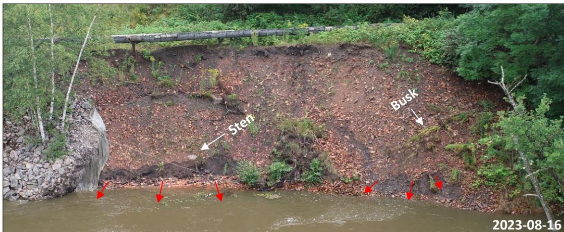
Figur 3.13: Dronefoto vinkelrett på erosjonssår nr. 2 ved ca. 2800 m 3 /s vannføring i Glomma, som viser tegn til bevegelse.
