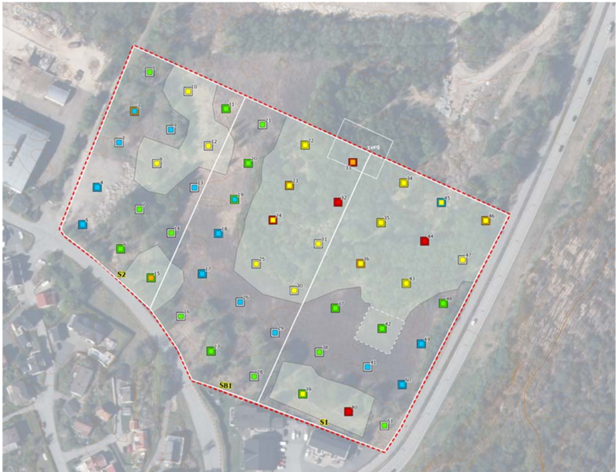
Figur 16 Plassering av prøvepunkter i øvre meter med forurensningstilstand, fargekodet iht. Miljødirektoratets helsebaserte tilstandsklasser. Kartet viser FMV5 Syd delt inn i felter, og markering av områder med lysegrønn som må masseutskiftes i øvre meter.
