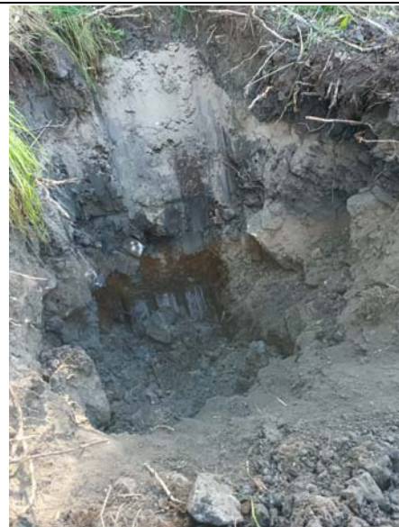
Foto 2. Prøvepunkt 6, matjord og sandige fyllmasser over flis og leire.
