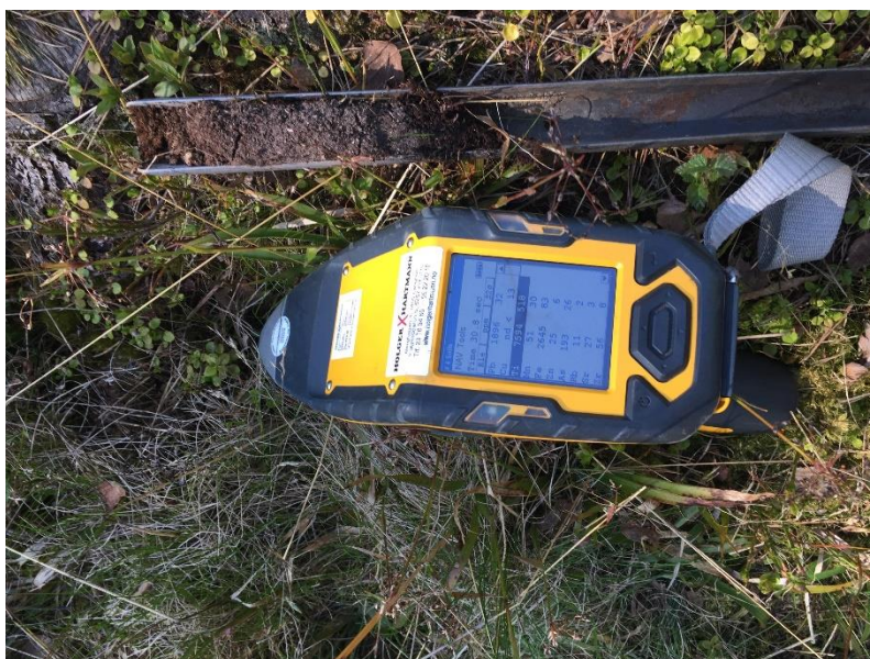
Figur 2 Det ble benyttet et XRF- instrument utlånt fra Holger Hartmann, samt jordbor for uttak av jordprøver fra jordprofil.
