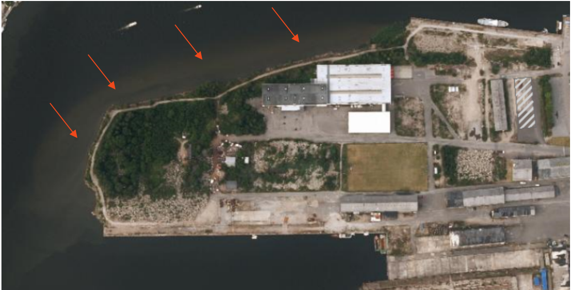
Figur 12: Flyfoto over Odden. Sedimentasjonssonen rundt Odden synes som et lysere og brunere felt enn resten av elva, her indikert med piler.
