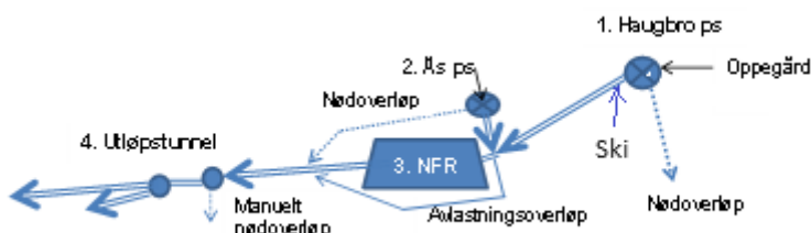
Figur 1 Skisse over avløpssystemet til NFRA.
