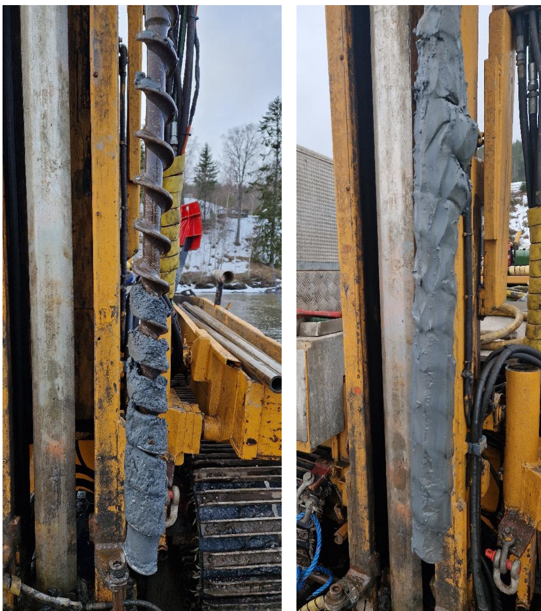
Figur 6: Eksempelbilde av prøvetakning fra flåte med borerigg.
