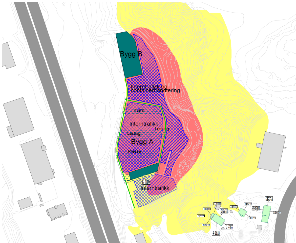
Figur 4 Støysonekart L_{den} som viser støyutbredelsen fra industrien med bidraget fra kverna og pressing av bilvrak. Beregningshøyde 4 meter.
