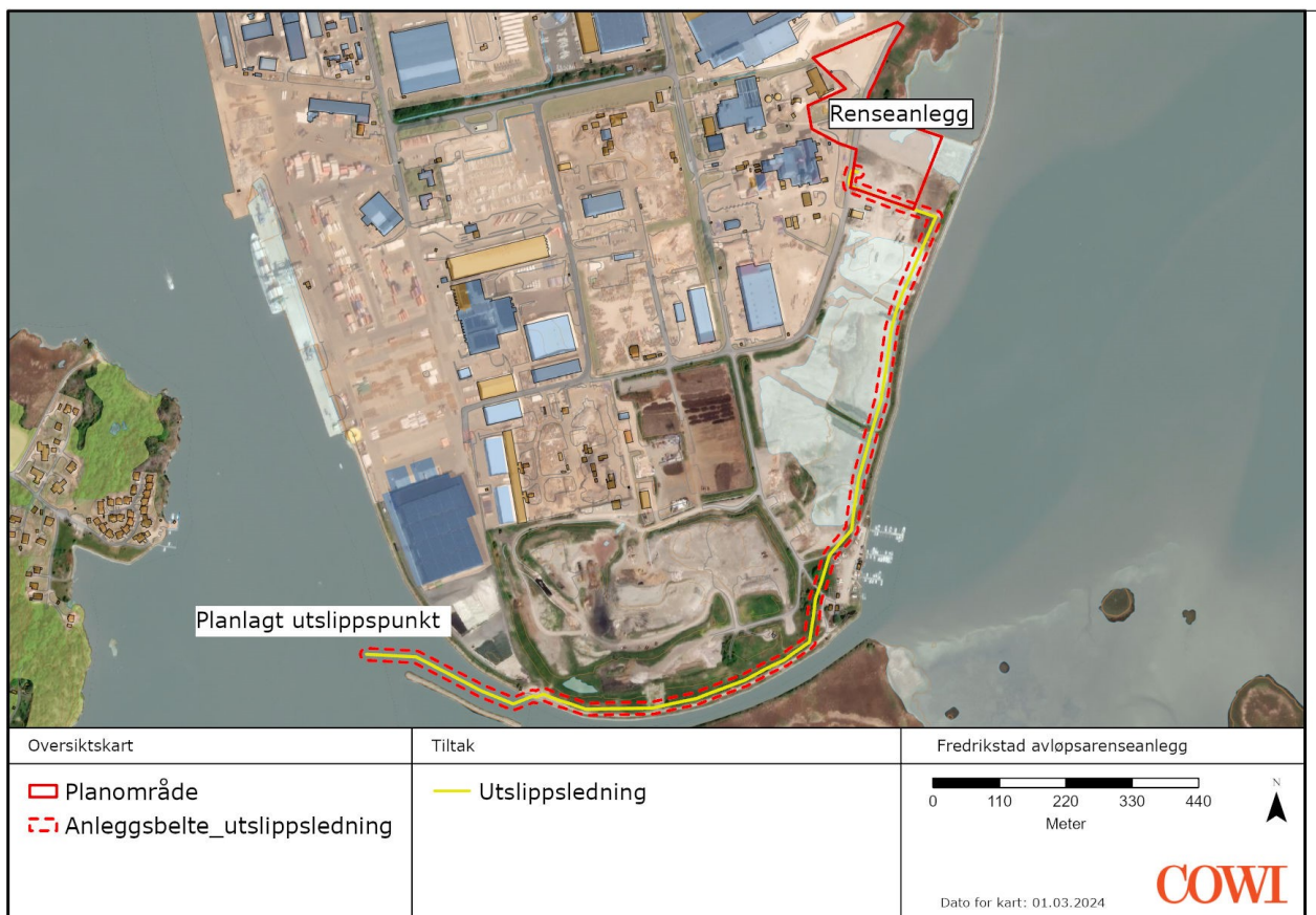
Figur 3-1, Illustrasjon over influensområdet. Planområdet for renseanlegget er inntegnet med rød stiplet linje og ledningsanlegget vises med brun stiplet linje.
