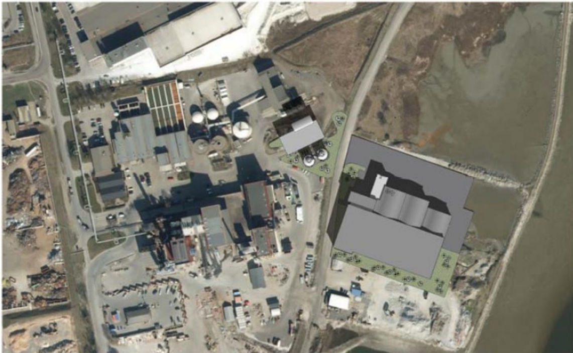
Figur 3. Plassering av nytt renseanlegg på tomt, øst for eksisterende anlegg. Vannbehandlingsbygget ligger lengst mot øst, og slambehandlingsbygget på vestsiden av tilkomstveien. Figuren viser ikke den planlagte rørbrua mellom byggene, den vises i Figur 5.
