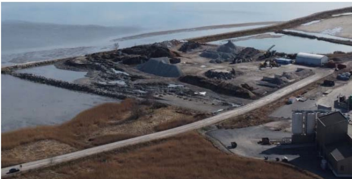
Figur 3. Plassering av nytt renseanlegg på tomt, øst for eksisterende anlegg. Vannbehandlingsbygget ligger lengst mot øst, og slambehandlingsbygget på vestsiden av tilkomstveien. Figuren viser ikke den planlagte rørbrua mellom byggene, den vises i Figur 5.
