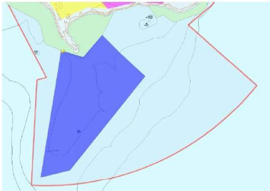
Figur 10: Område (blått) med fordelaktig undergrunn ut fra et stabilitetssynspunkt (Golder Associates)
