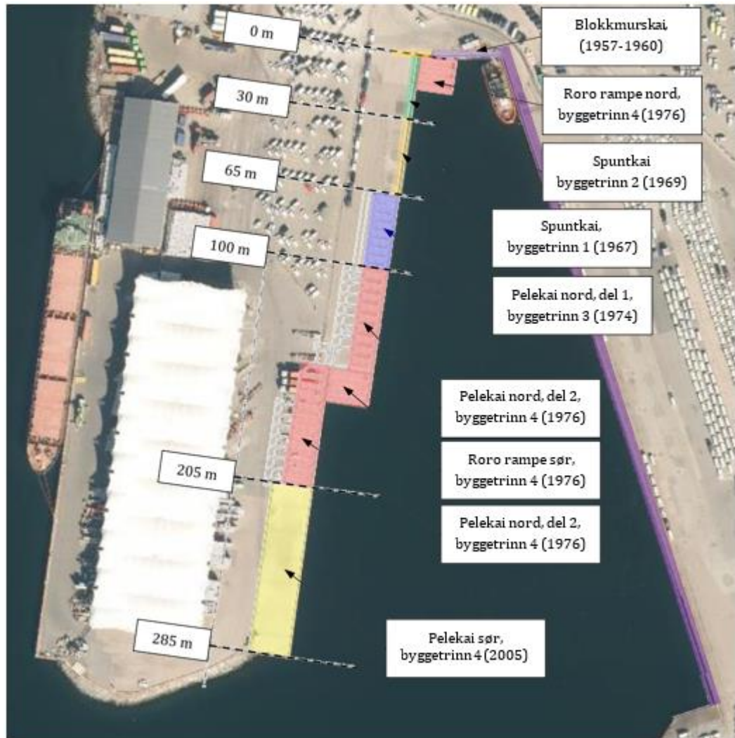
Figur 4-1 Oversikt over kaikonstruksjoner med estimert byggeår
